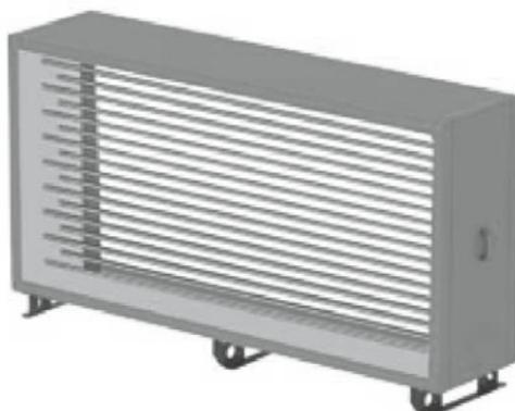
Секция электрического нагревателя серии РАЦИ представляет собой блок закрытых нагревательных элементов, собранных в бескаркасном корпусе с панелями из оцинкованной стали и слоем изоляционного материала. В корпусе секции, нагреватель устанавливается на направляющих, что позволяет выдвигать его из блока при обслуживании. Электронагревательные элементы установлены в секции горизонтально, а контакты выведены на клеммную колодку, установленную на боковой стенке
