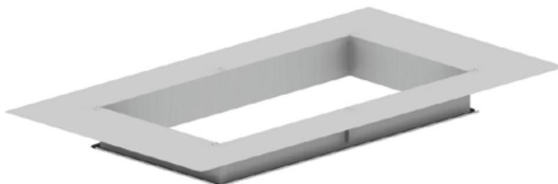
Патрубки используются для подсоединения к системе воздуховодов. Используются совместно со стаканами ССВпр и ССВИпр для установки на кровлю с прямоугольным проемом. Изготавливаются из листовой оцинкованной стали. Патрубки прижимаются к кровле нижним фланцем монтажного стакана.
