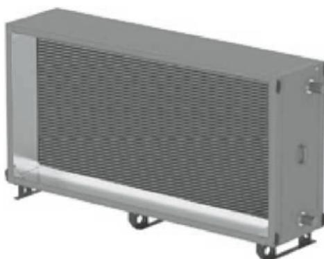
В секциях водяных воздухонагревателей приточных установок серии РАЦИ стандартно используются медно-алюминиевые пластинчатые 2-х, 3-х и 4-х рядные теплообменники с шагом между пластинами 1,6 мм. Уменьшенный шаг оребрения позволяет существенно увеличить теплоотдачу. Все водяные теплообменники испытаны на герметичность при давлении 30 бар.
