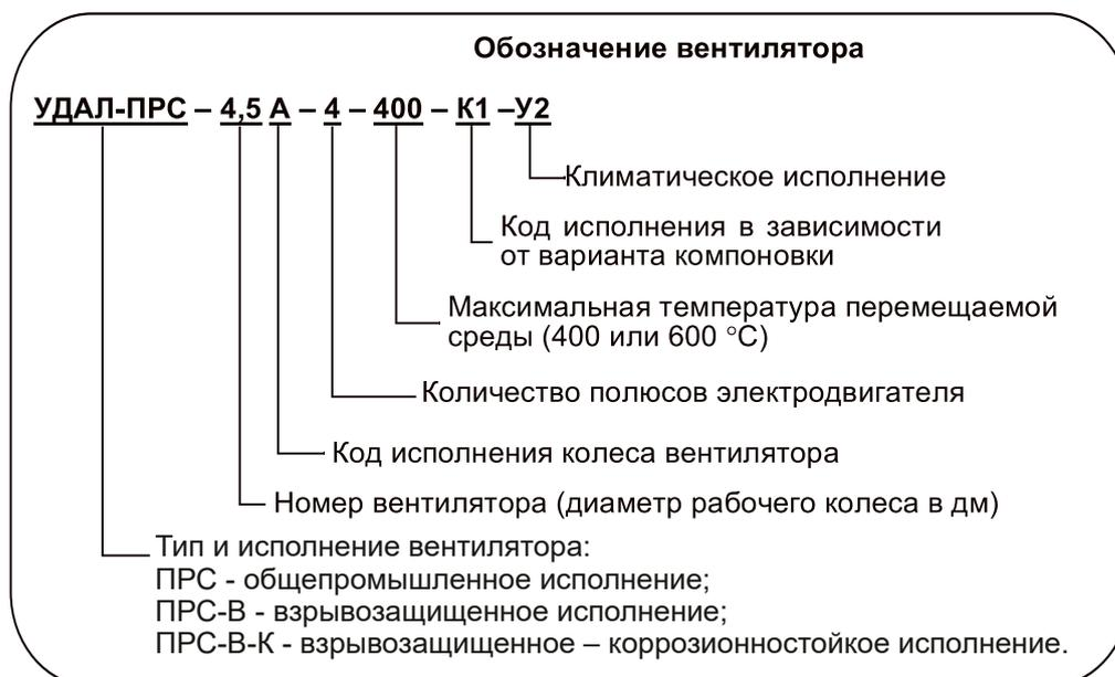
*Пример обозначения опций: козырёк с откидывающейся заслонкой, устанавливаемый на выходе из вентилятора для вентилятора УДАЛ-ПРС-6,3 будет обозначаться как ПРС-КК-6,3.*
