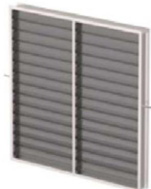
Воздушные клапаны вентиляционных установок РАЦИ представляют собой конструкцию из алюминиевого профиля с поворотными ламелями. Для поворота ламелей используются пластиковые шестерни и подшипниковые втулки. Уплотнение ламелей происходит за счет резинового уплотнителя, установленного на них. Ось механизма регулирования может быть расположена на любой из лопаток на любой стороне блока. Клапаны могут оснащаться ручным или электромеханическим приводом. Клапаны изготавливаются в сечение установки.
