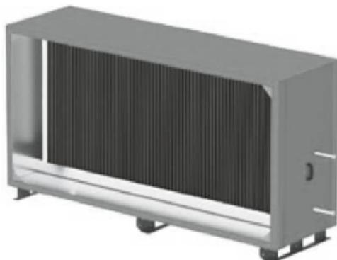
Секции фреоновых воздухоохлаждателей приточных установок серии РАЦИ стандартно укомплектованы медно-алюминиевыми пластинчатыми 2-х, 3-х и 4-х рядными теплообменниками с шагом между пластинами 1,6 мм. Уменьшенный шаг оребрения позволяет существенно увеличить теплоотдачу. Теплообменники заполнены инертным газом, для контроля герметичности. Конструкция секций фреоновых охладителей идентична секциям с водяным охладителем.
