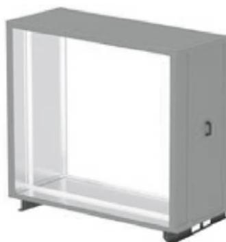
Секция обслуживания представляет собой пустую секцию с сервисной дверью и служит для выравнивания потока воздуха либо для облегченного доступа к элементам установки, требующим периодического обслуживания.
