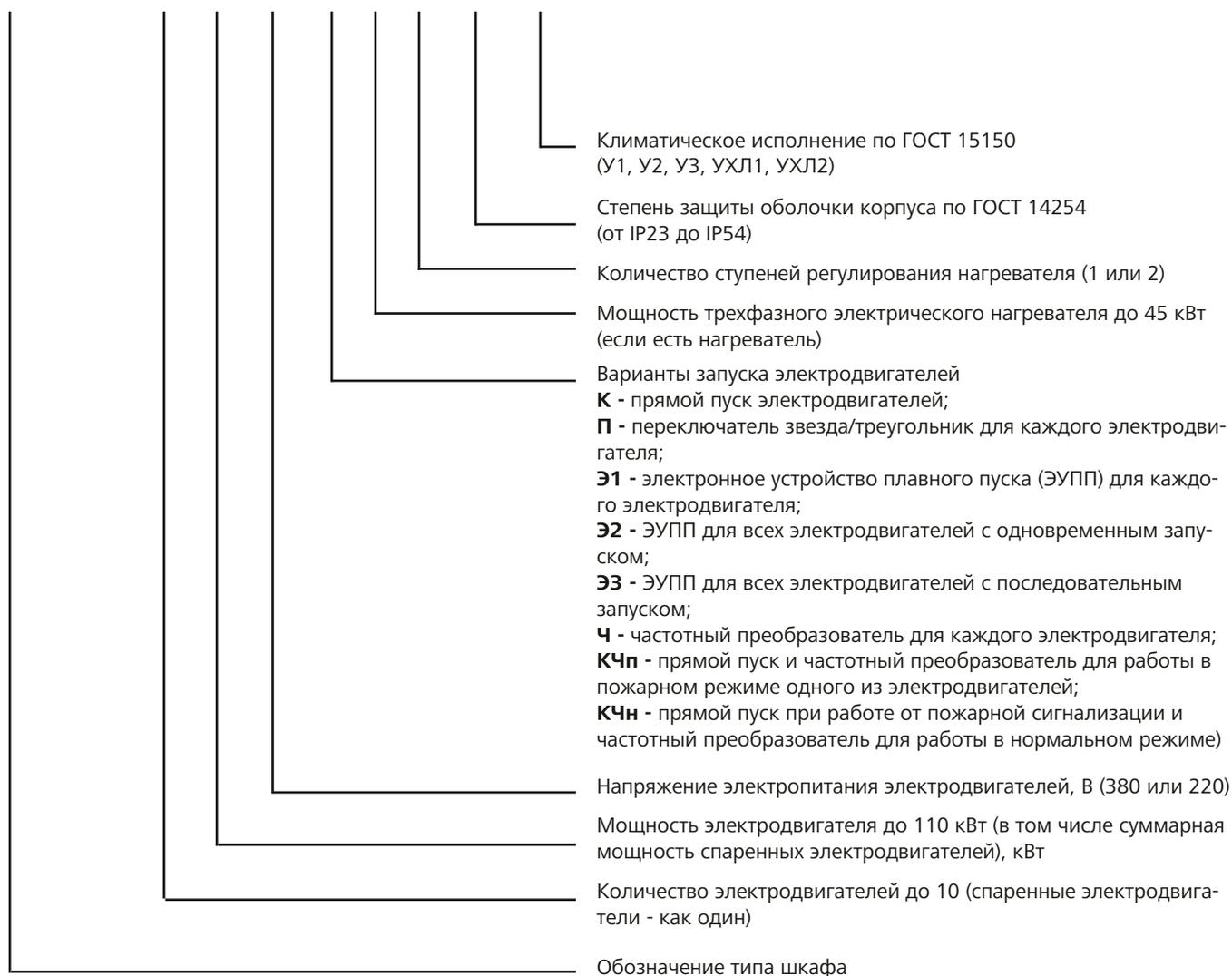
Основные технические характеристики, электрические схемы и габаритные размеры шкафов представлены в Руководстве по эксплуатации на конкретную модель изготовленную предприятием-изготовителем.
