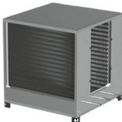
Секция форсуночного увлажнителя серии РАЦИ стандартно комплектуется блоком высокоэффективных форсунок, двумя каплеуловителями и нержавеющей поддоном. Распыление воды осуществляется навстречу потоку воздуха. Все детали внутри секции увлажнителя выполнены из нержавеющей стали и высококачественного пластика. Увлажнитель обеспечивает адиабатическое увеличение относительной влажности воздуха от 1 до 95%.
