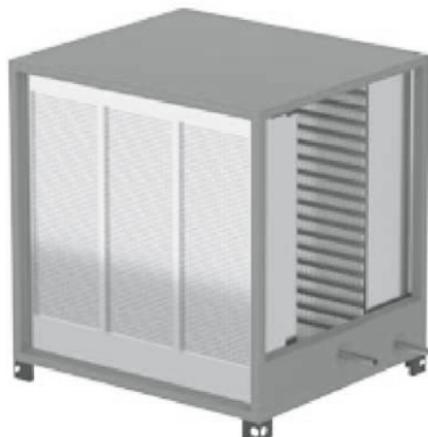
Секция сотового увлажнения вентиляционных установок серии РАЦИ представляет собой корпус с толщиной панели до 75 мм, в котором, на нержавеющей поддоне размещены увлажняющая кассета, специализированный насос и блоки водораспределительные головки. Все детали внутри секции увлажнителя выполнены из нержавеющей стали и высококачественного пластика.
