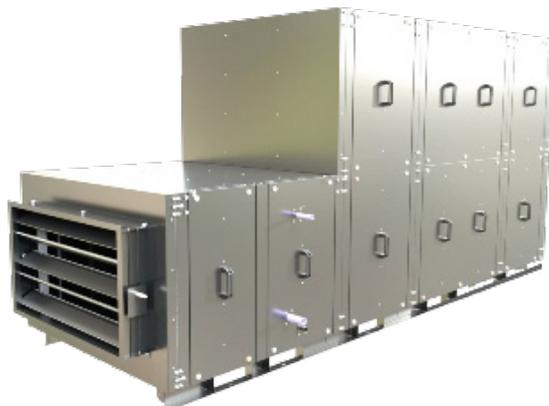
Вентиляционные агрегаты РАЦИ общепромышленного исполнения предназначены для создания и поддержания искусственного климата в помещениях промышленных и гражданских зданий, не имеющих специальных требований к вентиляционному оборудованию. Позволяют осуществить весь комплекс процессов обработки воздуха: фильтрацию, нагрев, охлаждение, увлажнение, осушение и рекуперацию. Размещаются только внутри зданий.
