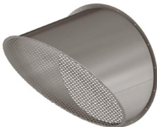
Защитный козырёк устанавливается на выходной фланец осевого вентилятора для защиты от попадания атмосферных осадков внутрь вентилятора при установке в горизонтальном положении снаружи здания. Козырёк изготавливается из оцинкованной стали и снабжается сеткой.
