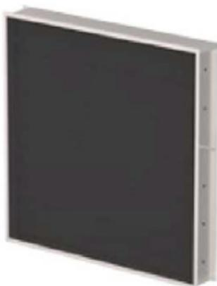
Утепленный воздушный клапан состоит из корпуса, выполненного из оцинкованной стали и укомплектованным саморегулируемым греющим кабелем, с присоединительными фланцами. В корпусе установлены лопатки поворотного типа, приводимые в движение системой рычагов и тяг. Под заказ возможна также установка трубчатых электронагревателей в местах сопряжения лопаток для облегчения их открытия в случае обмерзания в зимнее время.
