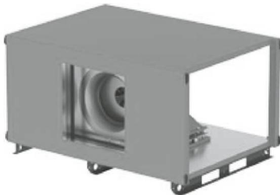
В секциях вентилятора установок серии РАЦИ применена компоновка со свободным рабочим колесом с прямым приводом на вал электродвигателя. Изменение числа оборотов электродвигателя достигается с помощью частотного регулятора. В секциях применяются асинхронные короткозамкнутые двигатели с усиленными подшипниками фирмы Siemens.
